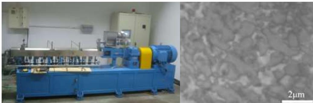
图3 双螺杆挤出机及 ACM/TPV 的相态结构
