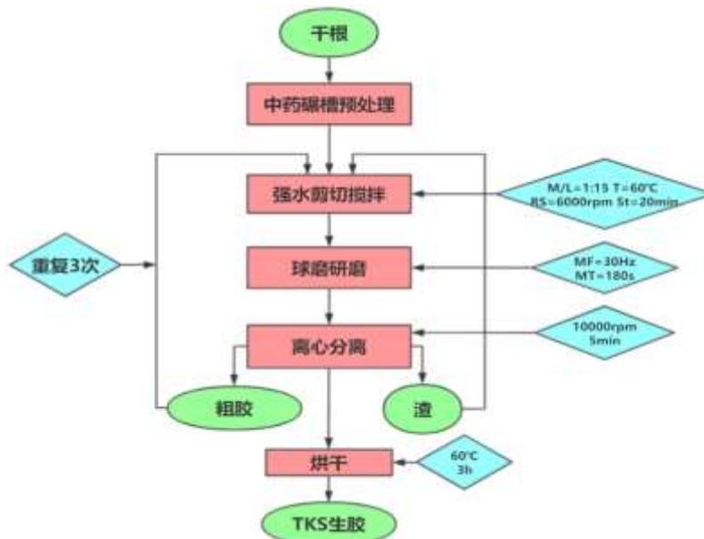
图 4-1 实验室级别的 TKS 提取工艺流程图
