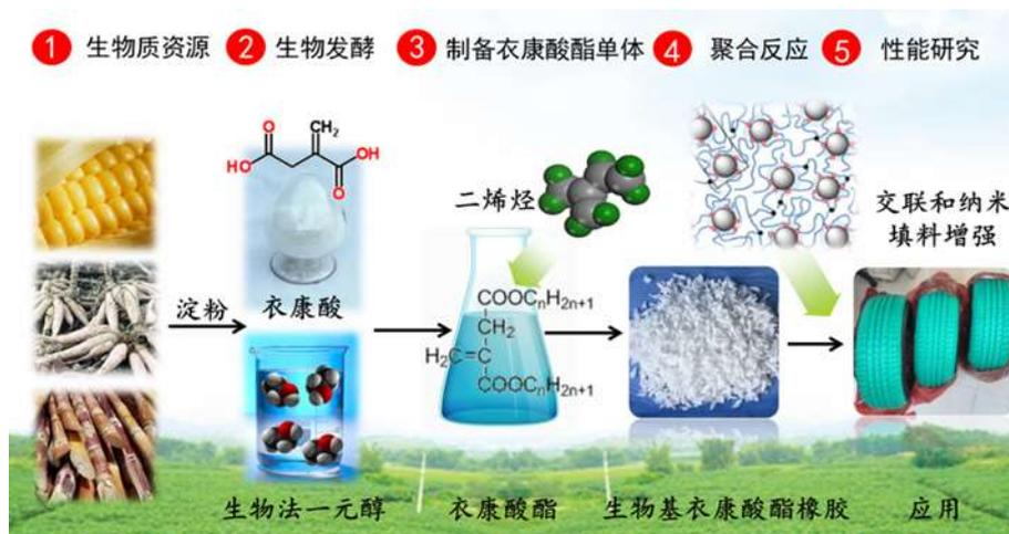
图 6 生物基衣康酸酯橡胶制备路线
