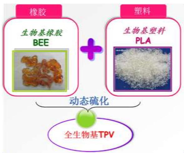
图 2 生物基 TPV 的制备
