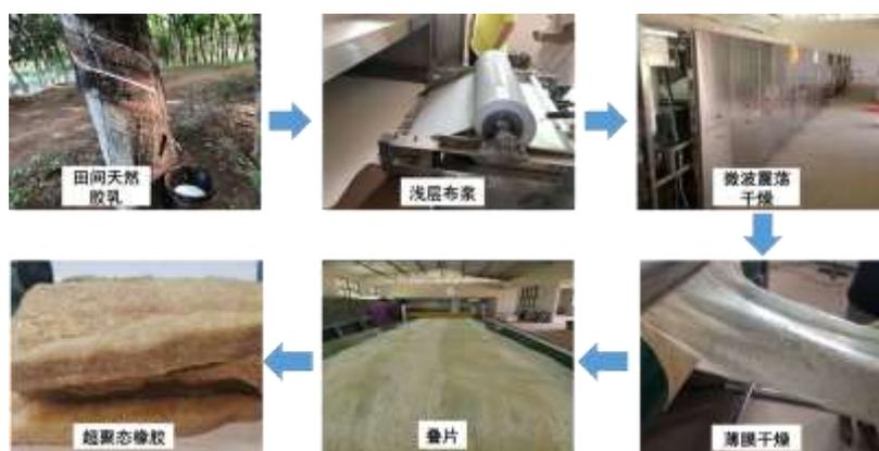
图 15 高性能超聚态橡胶材料现场制备图
