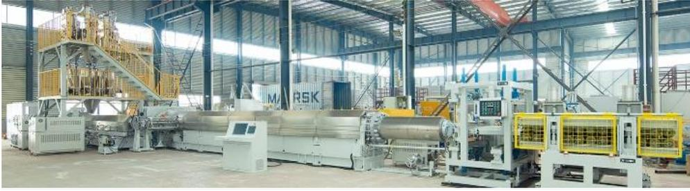
图 3 135-400 型 PS/CO2 发泡生产线
